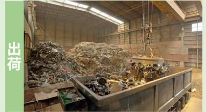
加工を行った金属屑は、製鋼原料として電気炉メーカーへ運搬します。
