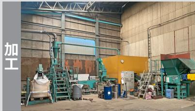
電線を投入後オートメーションで加工され電線の皮と銅に分けられます。
