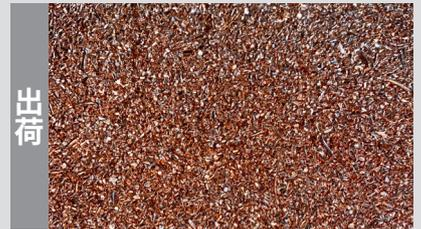
銅は米粒大の大きさになり、純度99.9%の高品質でメーカーに出荷します。
