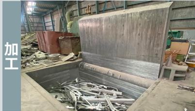
プレス機ボックス投入後圧縮加工されます。
